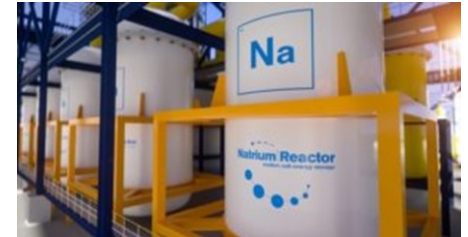
Sales fundidas (almacenamiento estacional)
